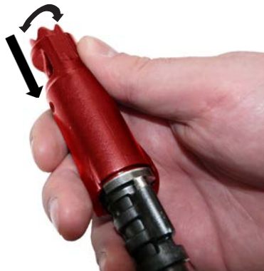
Рисунок 71 - Присоединение дульного тормоза
