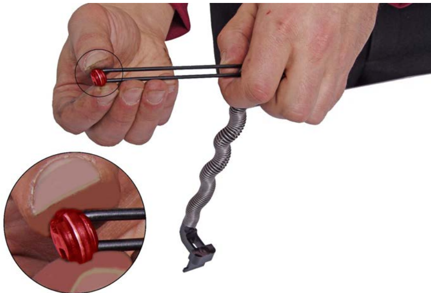
Рисунок 102 - Сборка возвратного механизма
