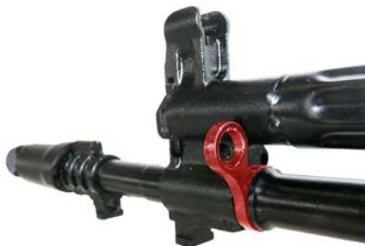
Рисунок 42 - Положение антабки необходимое для присоединения гранатомета 6Г34
