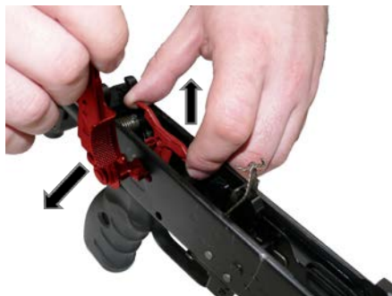
Рисунок 85 - Отделение переводчика и снятие механизма отсечки
