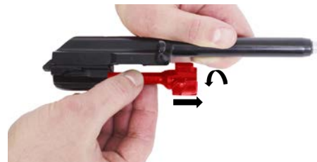
Рисунок 65 - Отделение затвора от затворной рамы
