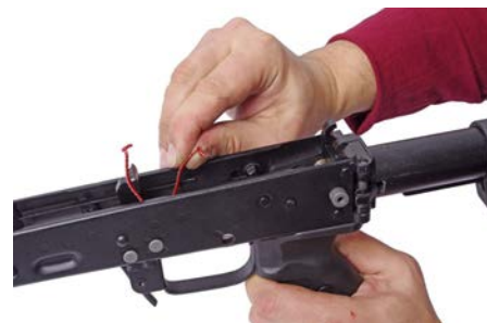
Рисунок 83 - Заведение правого конца боевой пружины за боевой взвод курка
