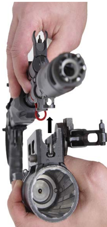
Рисунок 46 - Присоединение гранатомета 6Г15 к автомату
