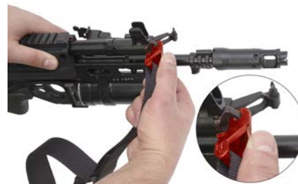
Рисунок 57 - Присоединение карабина ремня на прямоугольное отверстие заглушки газовой камеры автомата с установленным подствольным гранатометом 6Г15.
