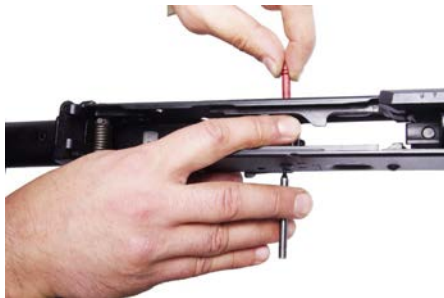
Рисунок 91 - Вставление оси автоспуска
