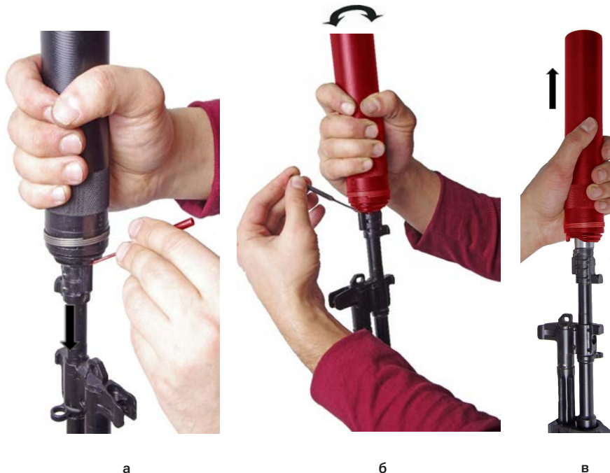
а – нажать выколоткой на фиксатор, б – повернуть ПМС, в – снять ПМС вперед.
