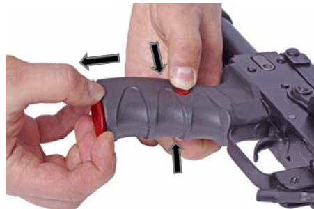
Рисунок 60 - Извлечение пенала из рукоятки
