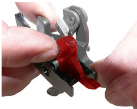
Рисунок 97 – Установка шептала одиночного огня
