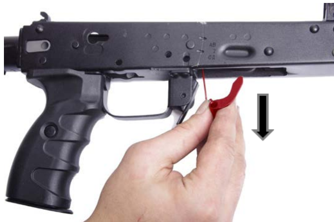
Рисунок 89 - Извлечение автоспуска с пружиной из ствольной коробки
