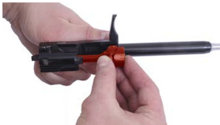
Рисунок 68 - Положение затвора относительно рамы затворной для установки его в раму затворную
