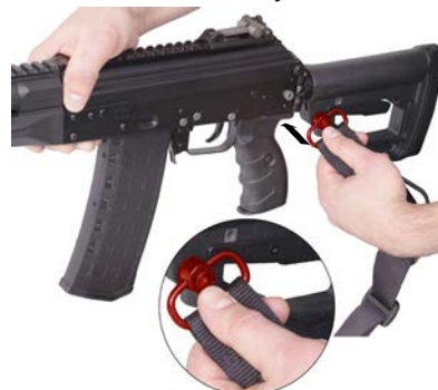
Рисунок 50 - Закрепление антабки ремня во втулке корпуса приклада в сборе
