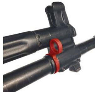
Рисунок 43 - Положение антабки необходимое для присоединения гранатомета 6Г15
