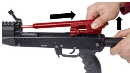
Рисунок 64 - Отделение затворной рамы с затвором
