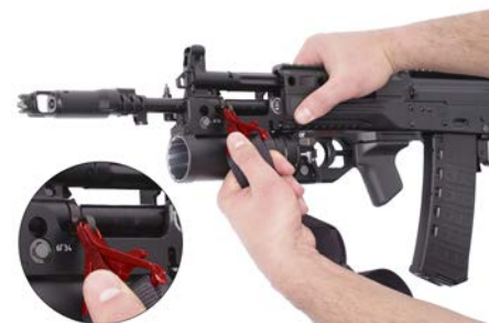
Рисунок 55 - Присоединение карабина ремня на антабку автомата с установленным подствольным гранатометом 6Г34
