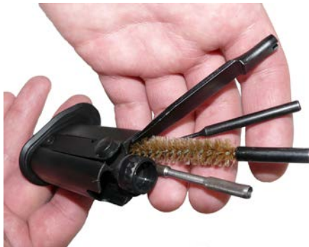
Рисунок 78 – Установка принадлежности в пенал
