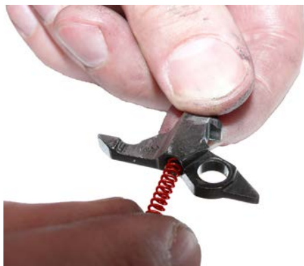
Рисунок 96 – Установка пружины шептала
