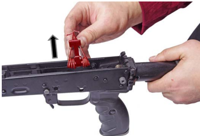
Рисунок 88 - Извлечение курка из ствольной коробки
