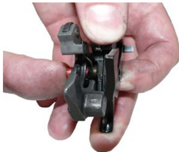
Рисунок 100 – Установка шептала отсеки
