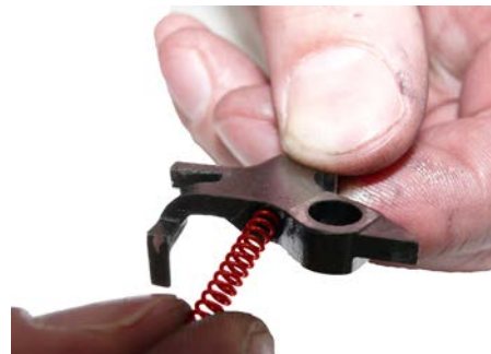
Рисунок 98 – Установка пружины шептала отсечки
