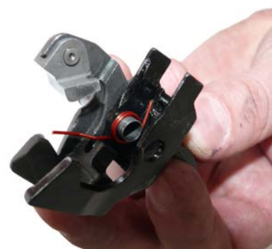
Рисунок 95 – Установка пружины замедлителя
