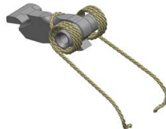
Рисунок 92 - Положение боевой пружины на курке
