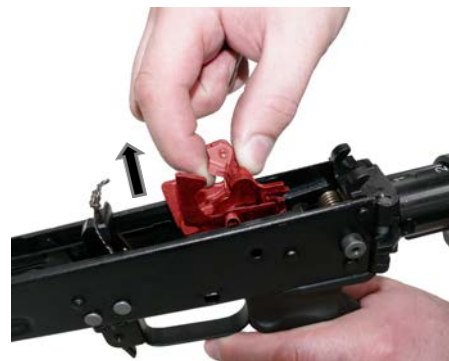
Рисунок 86 - Отделение узла спускового механизма
