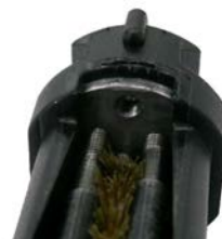
Рисунок 76 - Расположение резьбовых отверстий для шомпола
