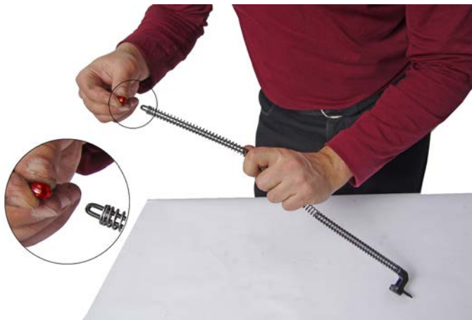
Рисунок 81 – Отделение муфты возвратного механизма
