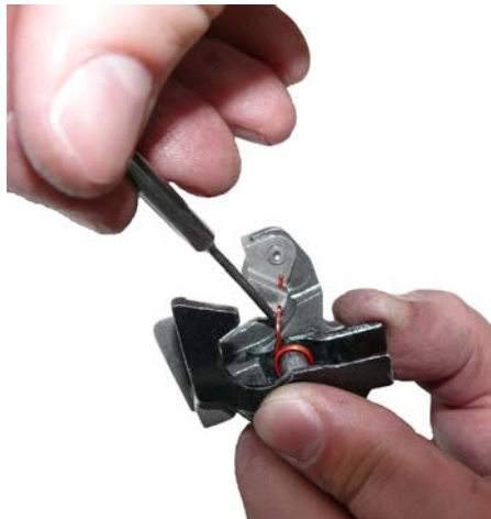
Рисунок 99 – Установка пружины замедлителя
