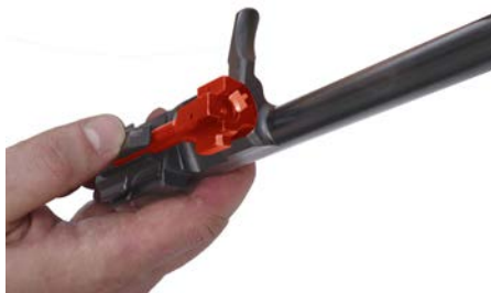
Рисунок 69 - Положение затвора относительно рамы затворной для присоединения рамы затворной с затвором в сборе к ствольной коробке.
