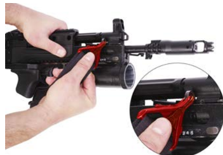
Рисунок 56 - Присоединение карабина ремня на антабку автомата с установленным подствольным гранатометом 6Г15
