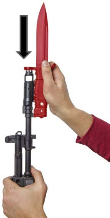
Рисунок 34 – Крепление штыка-ножа 6Х9-1
