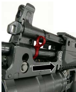
Рисунок 44 - Установка подствольного гранатомета 6Г34
