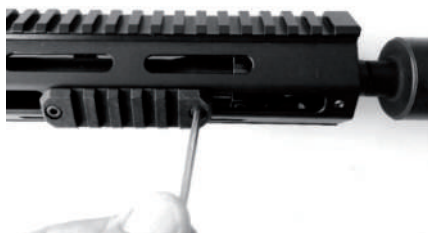
Рис. 120. Кріплення планки «пікатіні» на цівку з різьбовим кріпленням планок
