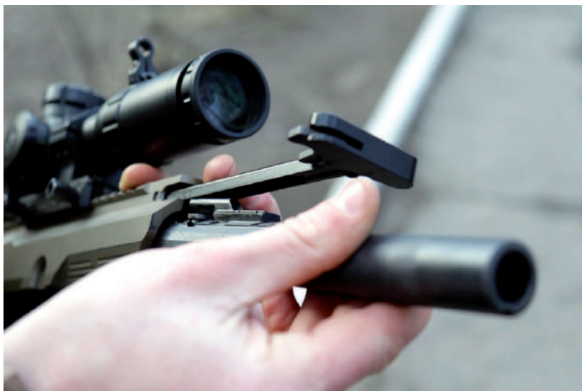
Рис. 84. Від'єднання затворної рами із затвором від корпусу гвинтівки: 1 – затворна рама; 2 – важіль перезарядження
