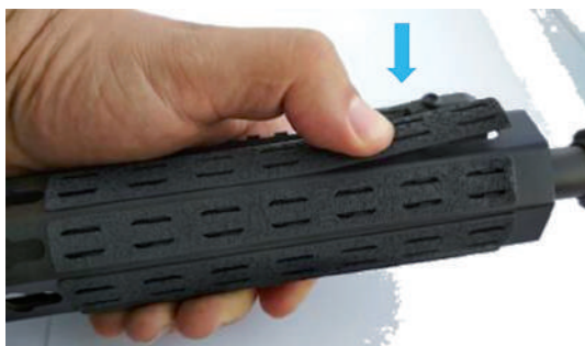
Рис. 121. Кріплення планки «Пікатіні» на цівку з кріпленням типу кеймод (KeyMod)
