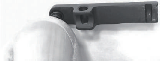
Рис. 110. Утримання пружини викидача під час її зняття або встановлення
