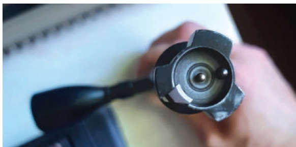
Рис. 135. Вигляд голівки затвора із трьома бойовими виступами та чашечки затвора із ударником, викидачем та відбивачем
