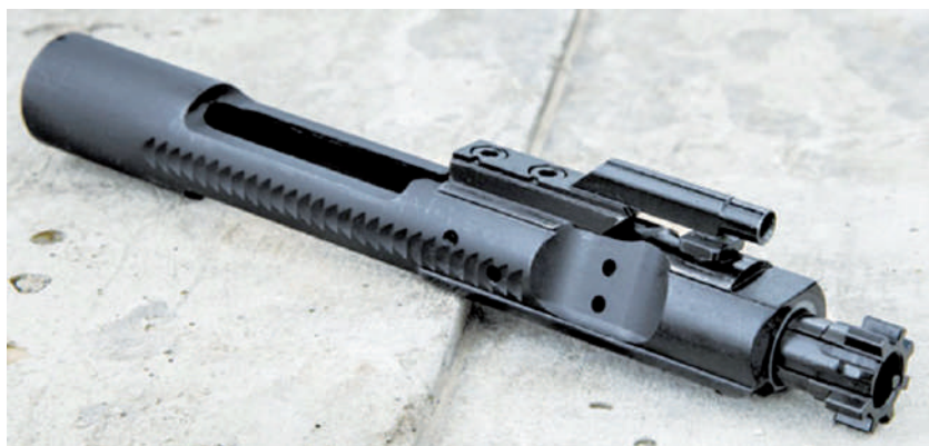
Рис. 83. Зовнішній вигляд затворної рами автоматичної гвинтівки із голівкою затвора у зборі:
