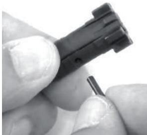
Рис. 111. Утримання викидача під час встановлення осі викидача
