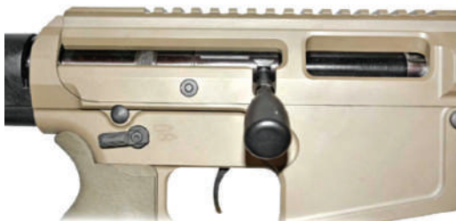
Рис. 131. Болтова система запирання каналу ствола
