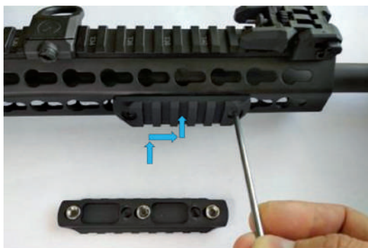
Рис. 121. Кріплення планки «Пікатіні» на цівку з кріпленням типу кеймод (KeyMod)
